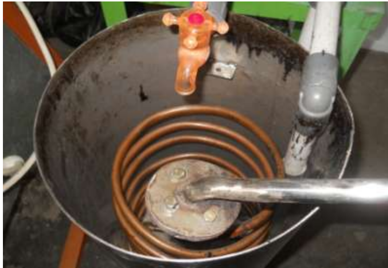
Gambar 3.7. Kondensor mengubah gas asap menjadi cairan
