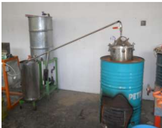
Gambar 3.4 Unit alat penghasil asap cair
