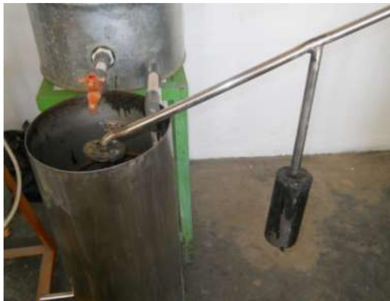
Gambar 3.6 Distribusi asap dari pirolisator ke kondensor
