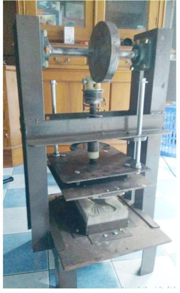
1. Buat rangka utama ukuran 300 mm × 300 mm dengan tinggi 150 mm
