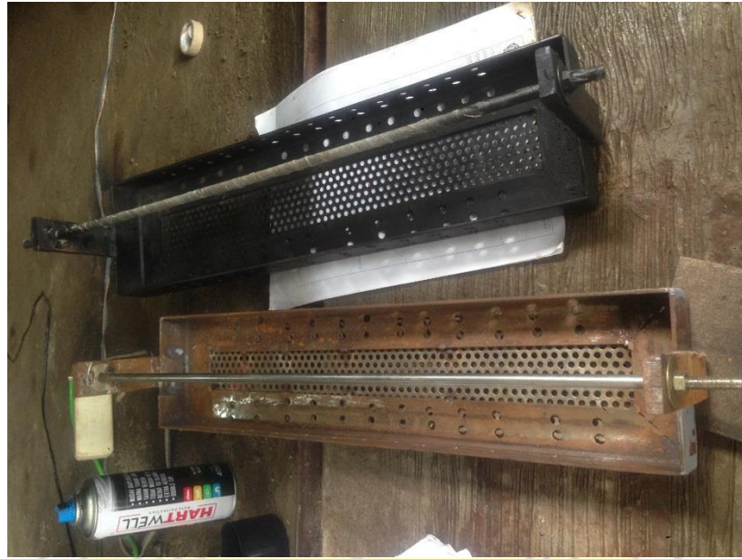
Gambar 4. 15 Pengelasan Rak Penampung
