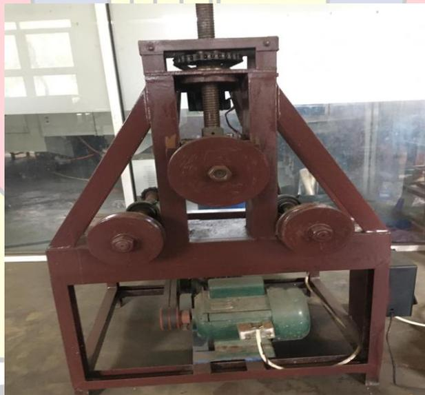
Gambar 3.12 Mesin Roll Pipa ( 1 )
