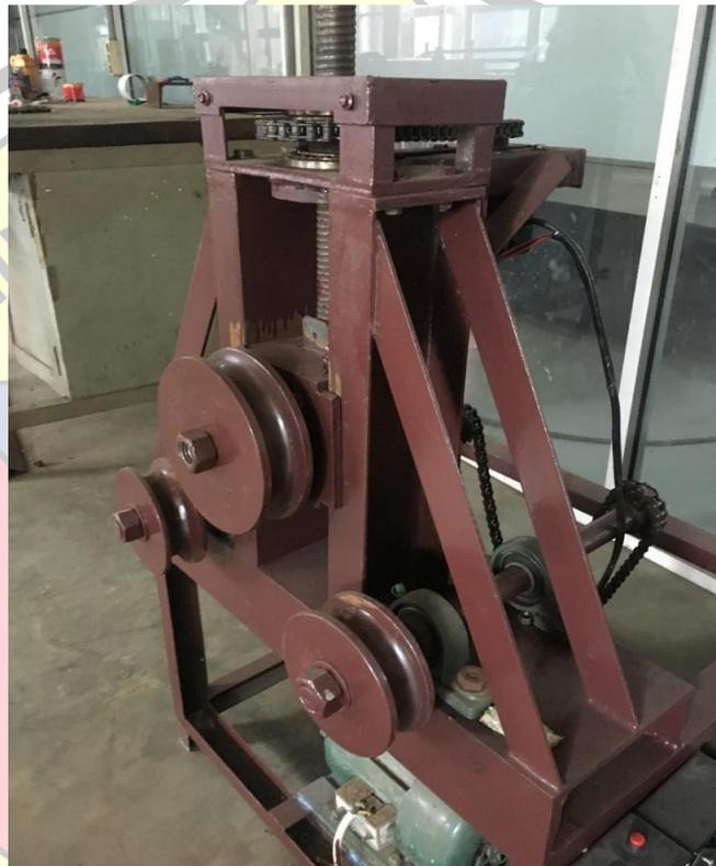
Gambar 3.8 Rangka Mesin Roll Pipa
