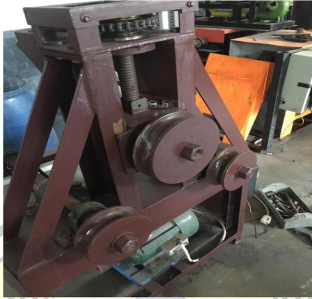
Gambar 3.13 Mesin Roll Pipa ( 2
