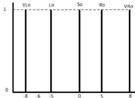
Gambar 8. Fungsi Keanggotaan Kendali Motor Servo Sb. x
