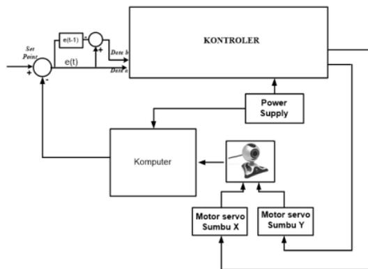
Gambar 10. Diagram Blok Sistem Penggerak Kamera 2 axis
