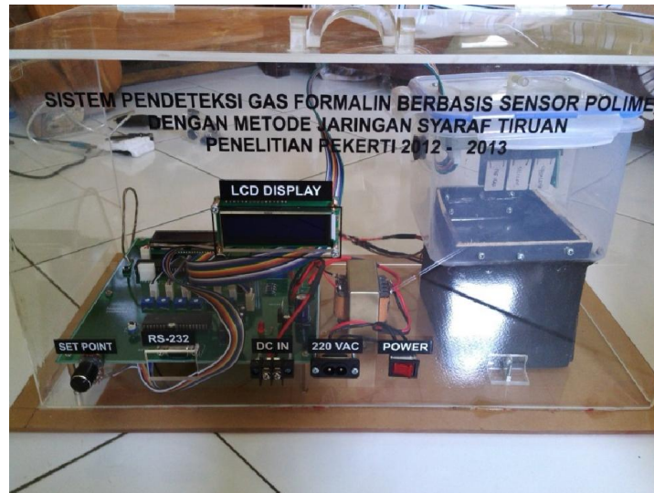
Gambar 16a. Gambar realisasi keseluruhan sistim deteksi formalin pada bahan makanan
