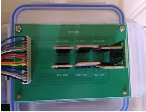
Gambar 10. Konfigurasi letak sensor dalam board terintegrasi
