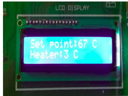
b. LCD sebagai setting point suhu
