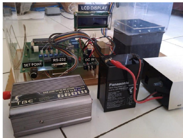
Gambar 16b. Sistim deteksi formalin pada bahan makanan beserta power supplynya
