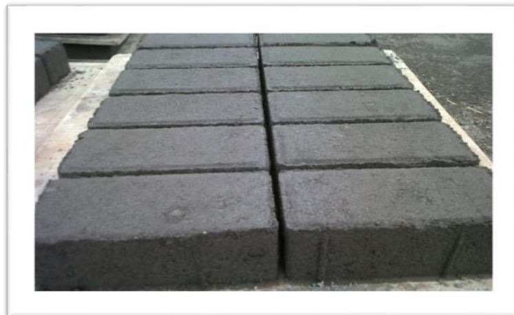
Gambar 13. Paving blok hasil cetakan mesin press dengan sistim pneumatik
