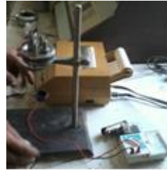
Gambar 4 mengecek menggunakan ampere meter Mengisi oksigen kedalam combustion capsule untuk membantu proses pembakaran
