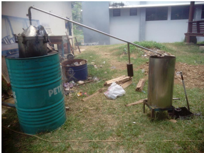
Foto 8. Alat destilator fenol (asap cair) sbg zat pengikat
