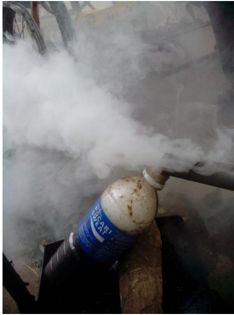
Foto 9. Proses pembuatan fenol (asap cair) sbg zat pengikat
