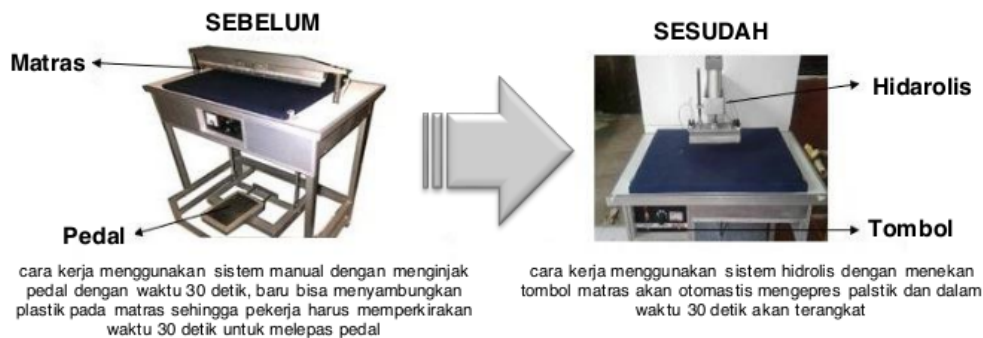
Gambar 2. Peningkatan mesin press manual menjadi hidrolis
