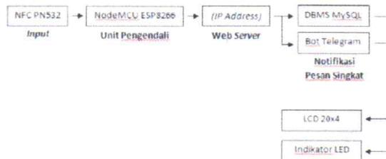
Gambar 3. Perancangan Diagram Blok *Hardware*
