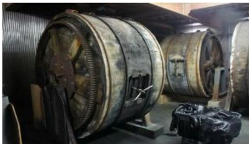
Gambar 4. 13 Drum yang berisi kulit sebagai proses dari penyamakan minyak
