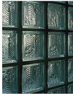
Gambar 2. 21 Kaca pengecoran kiln berpola dekoratif untuk jendela
