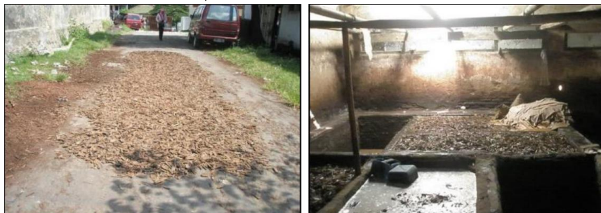
Gambar 4. 11 Penjemuran Bahan Baku Kulit Akasia dan Proses Penyamakan Nabati Dengan Cara Perendaman
