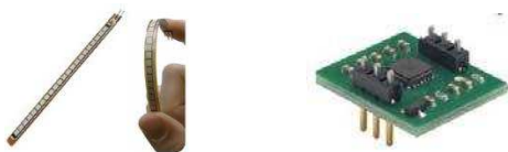
(a) Sensor flex (b) accelerometer Gambar 2. Sensor yang digunakan
