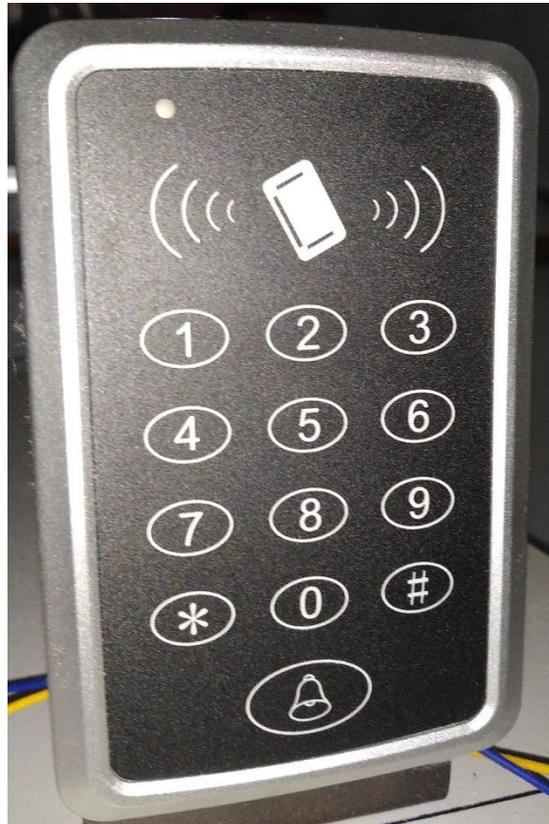
1. Ketik kode program (**#123456#1**) pada keypad sensor RFID.
