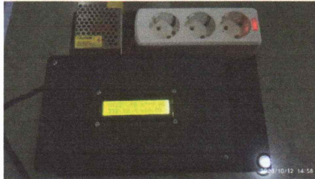
Gambar 5. Alat Koreksi Faktor Daya Beban Listrik Pada Industri Rumah Tangga
