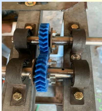
Gambar 3.26 Kunci Roda Gigi Menggunakan Mur dan Baut
