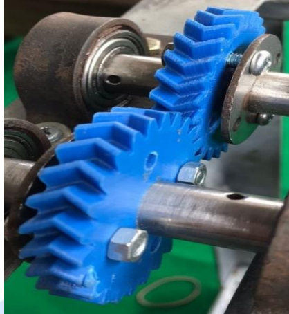
Gambar 3.27 Posisikan Roda Gigi Menempel pada Poros 1 dan Poros 2
