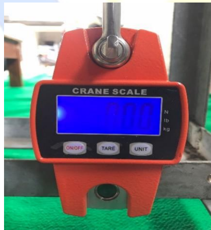
Gambar 3.28 Nyalakan Timbangan Digital Gantung
