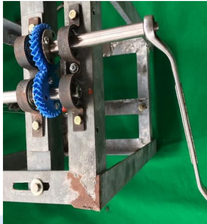
Gambar 3.29 Letakan Kunci pada Poros Penggerak Roda Gigi 2
