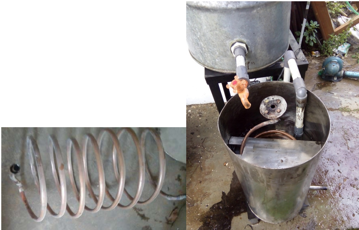
Kondensor bentuk koil
