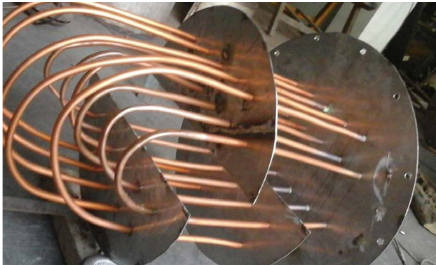
Kondensor bentuk pipa U
