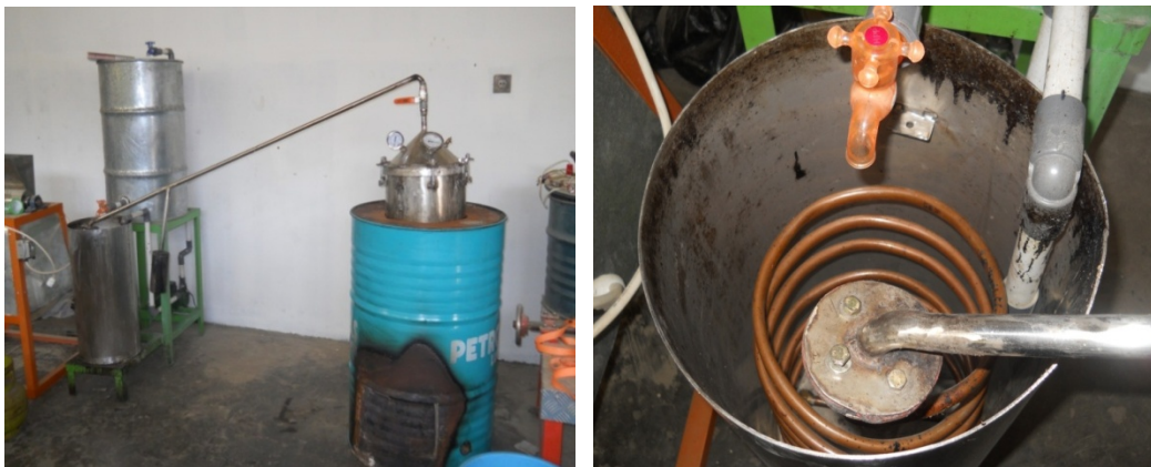
(a) (b) Gambar 3. Perangkat penghasil asap cair ( a) pirolisator (b) kondensor
