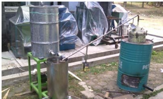
Gambar 2. Pirolisator asap cair
