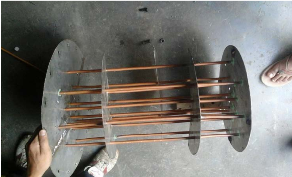
Kondensor bentuk pipa sejajar atau I
