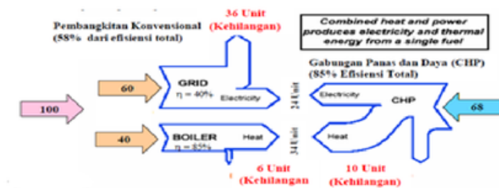
Gambar 1. Pembangkit Konvensional Vs Kogenerasi [2]
